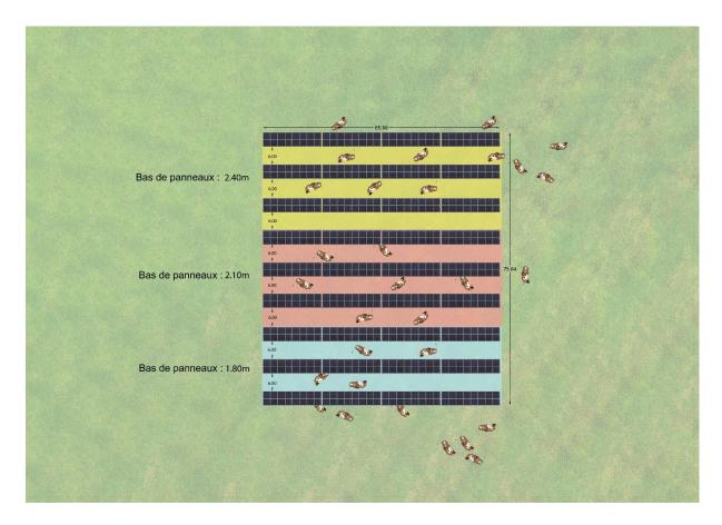
Situé sur une exploitation agricole familiale, le démonstrateur regroupe 9 rangées de panneaux solaires de 84 panneaux chacune sur plus de 4 300 m². Chaque rangée est espacée de 6 mètres pour favoriser le passage des machines agricoles et la hauteur des structures est variable (1.80, 2.10 ou 2.40 mètres) afin d'étudier l'impact de la hauteur sur le comportement des bovins.
